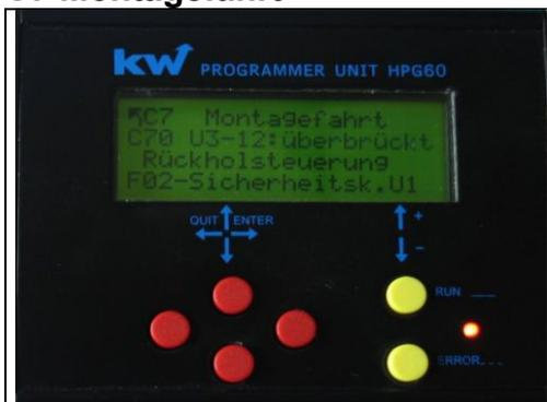
Im **Untermenü C7, Punkt C70 Montagefahrt** kann bei aktiver Rückholsteuerung dieser Parameter aktiviert werden. Bei der Montage einer Aufzugsanlage sind am Anfang die Schalter des Sicherheitskreises noch nicht gesetzt. Diese Funktion ermöglicht, obwohl die Sicherheitseingänge U3 bis U12 ohne Spannung sind, eine Fahrbewegung mit der Rückholsteuerung. Voraussetzung ist, dass an U1 und U2 Spannung anliegt.
