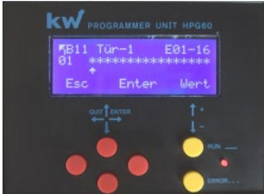
Das Handprogrammiergerät HPG60 weist 6 Tasten, ein vierzeiliges LCD-Display, eine rote Leuchtdiode, sowie eine 9-polige RS232-Schnittstelle auf.
