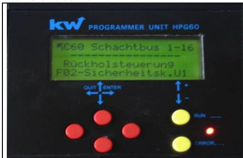
Im **Menü C60 Gerätekontrolle** wird im **Unterpunkt ER 00 bis 16 und ER16 bis 32** der Zustand aller Geräte am Schachtbus, d.h. alle Etagenrechner und Zusatzgruppen, ausgegeben.
