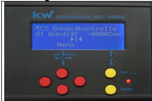
Im **Untermenü C5 Bündigkeitskontrolle** wird die aktuelle Position des Fahrkorbes zum absoluten Bündigwert in mm ausgegeben.
