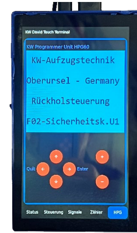
HPG-Oberfläche zur Parametereingabe
